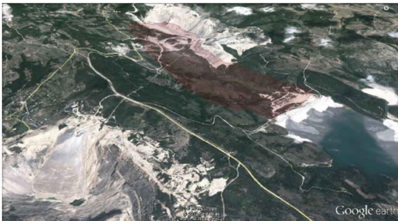
Slika 34. Prikaz simulacije poplavnog talasa usled rušenja brane 1.
