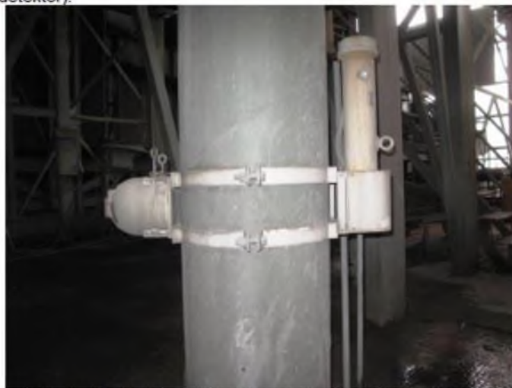
Slika 1. Merni sistem (kontejner sa izvorom ^{137}\text{Cs} – detektor).
