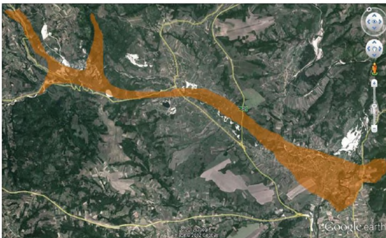
Slika 36. Prikaz simulacije poplavnog talasa usled rušenja brane 2 i 3.
